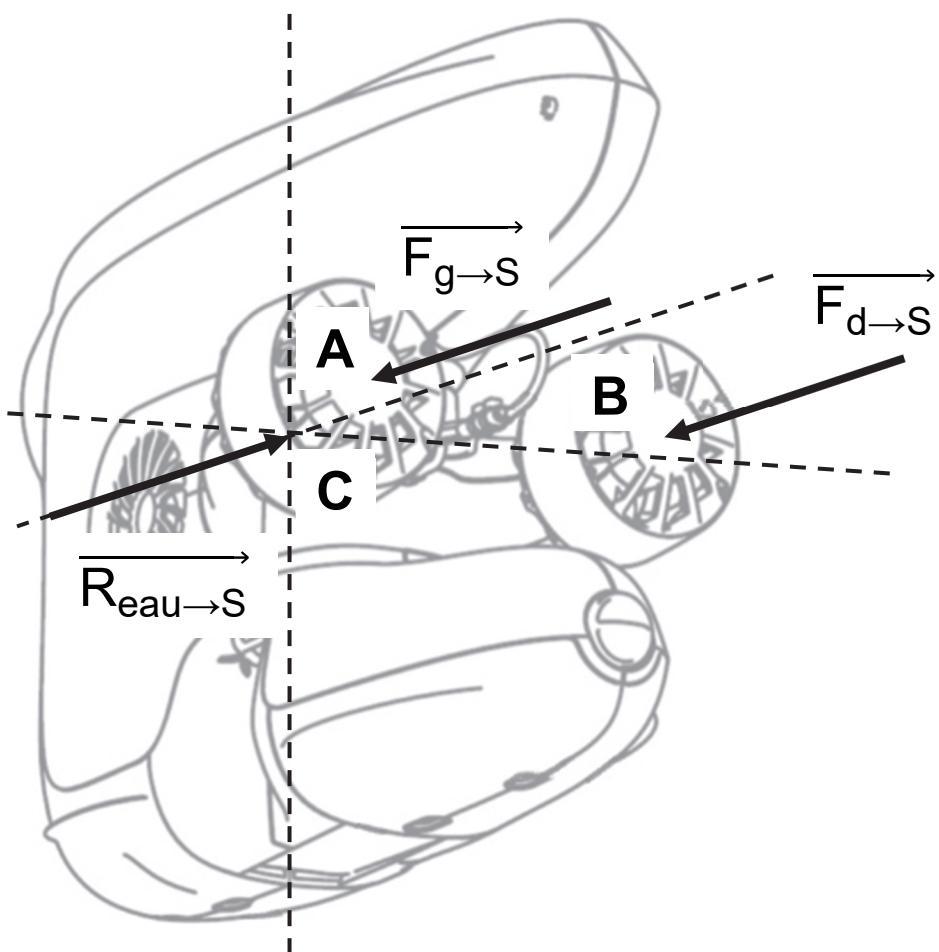
**Question 1.8 :** À l'aide du théorème de la résultante dynamique en projection sur  $\vec{x}$ , établir la relation entre la poussée  $T$  de chaque propulseur, la trainée  $R$ , l'accélération  $a$  et la masse  $m$  du drone dans le sens du mouvement.
