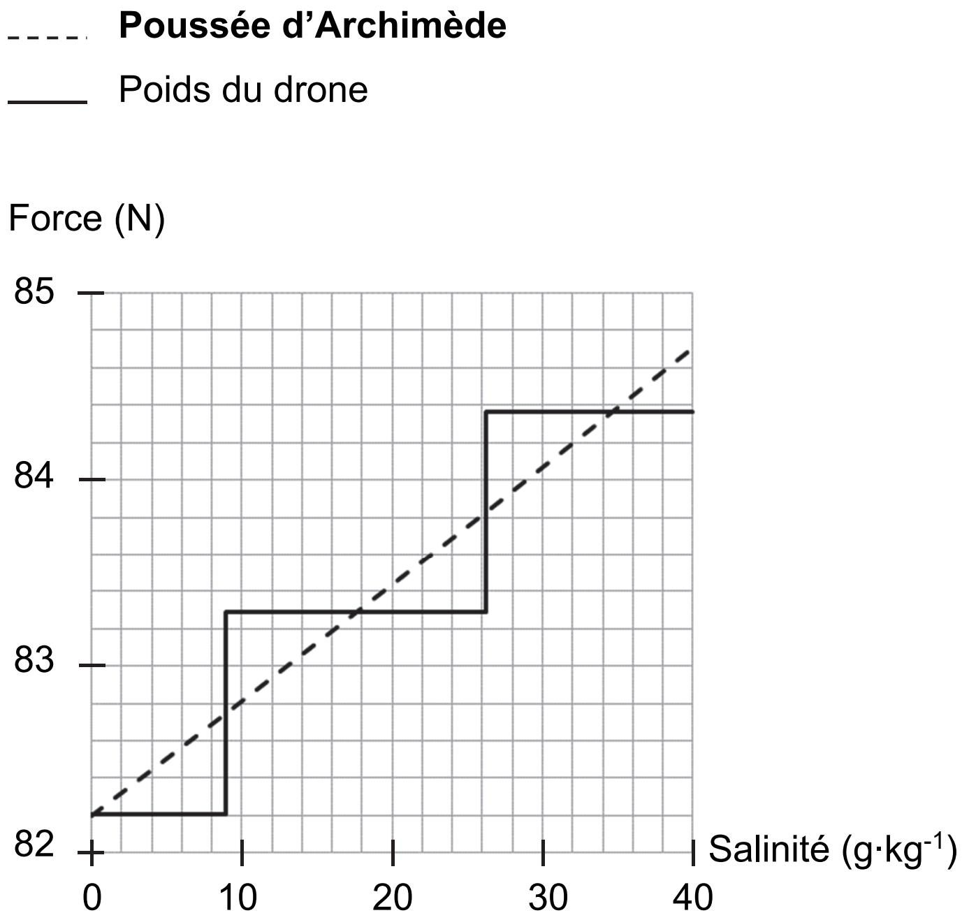
L'utilisateur est suffisamment expérimenté pour choisir, en fonction de l'eau dans laquelle il utilise le drone, la meilleure configuration possible : aucun lest, une masse additionnelle, ou deux.
