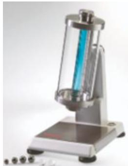
La viscosité est une grandeur physico-chimique caractéristique d'un fluide qui traduit la résistance de ce fluide au mouvement. Plus la viscosité du fluide est élevée, plus le fluide s'écoule difficilement. La valeur de la viscosité dépend de la température du fluide et elle s'exprime en  $\text{kg}\cdot\text{m}^{-1}\cdot\text{s}^{-1}$ .
