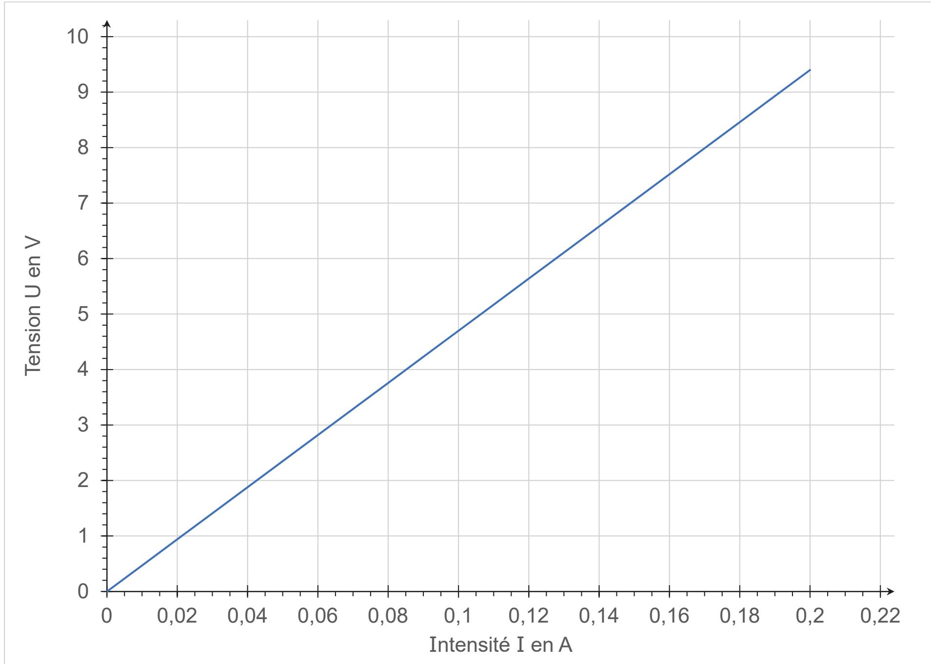
**Question 8 (2 points).** À l'aide du graphique ci-dessus, déterminer la valeur de la tension aux bornes de la résistance quand elle est traversée par un courant d'intensité de valeur égale à  $0,19 \text{ A}$ .
