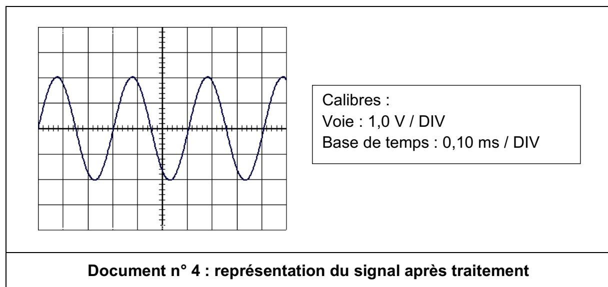
4. Déterminer, à partir de l'oscillogramme représenté sur le document n°4, la fréquence  $f_D$  mesurée par le radar.
