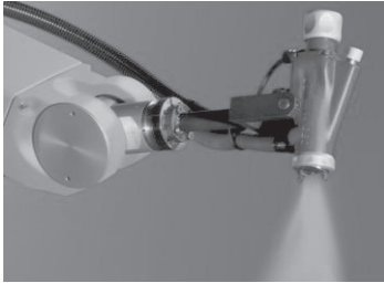
Figure 4 : pistolet de peinture installé en bout de bras
