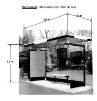
En exploitant le document et en effectuant les calculs nécessaires, indiquer si ce toit d'abri de bus peut résister à une épaisseur de neige fraiche de 50 cm.
