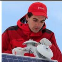
SR20-D2 pyranomètre étalon secondaire avec sortie numérique pour les mesures du GHI (rayonnement global horizontal) et du POA (dans le plan des modules)
