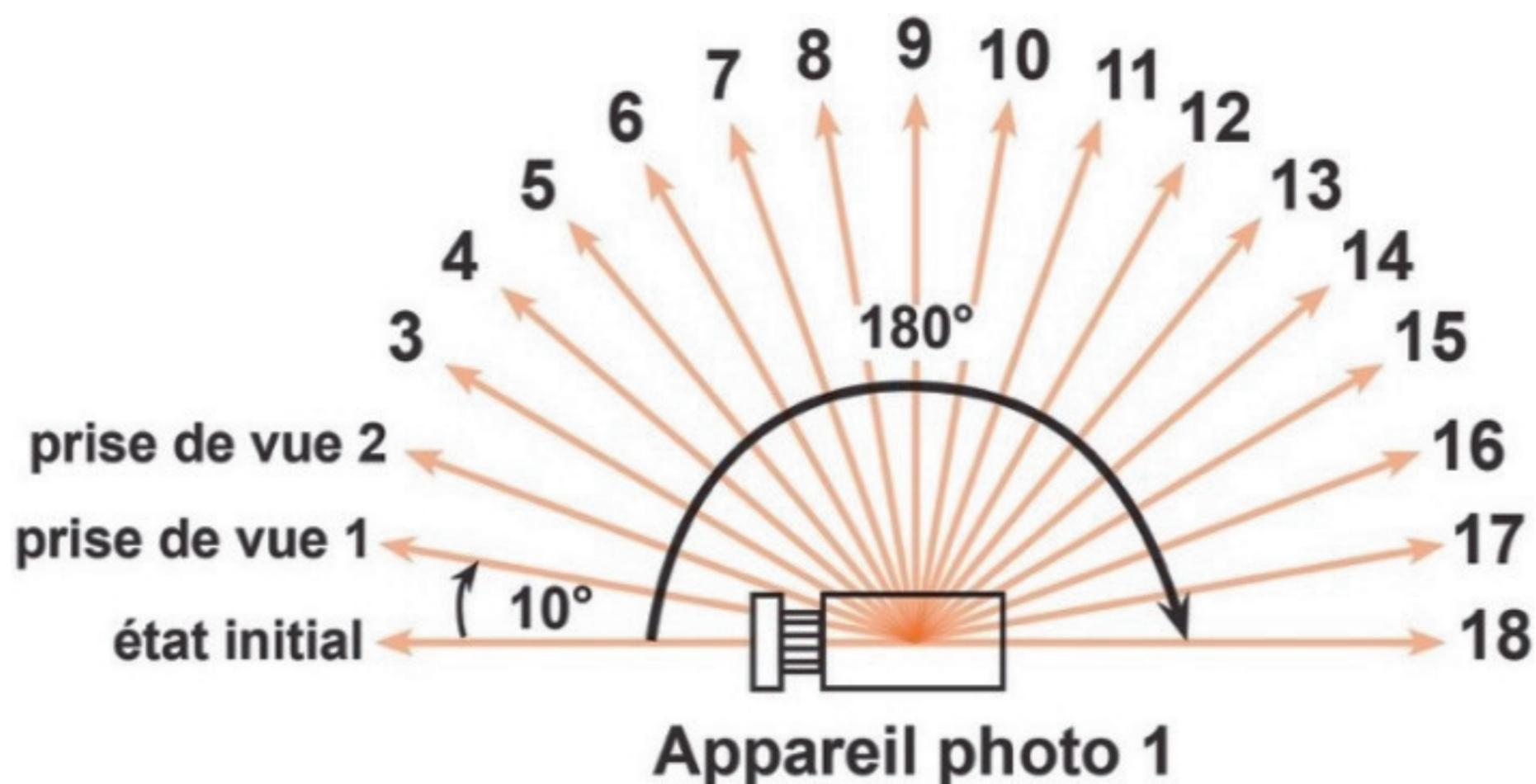
Au départ du cycle, l'appareil photo est orienté vers la position initiale d'angle  $0^\circ$  (noté « état initial »). Il pivote de  $10^\circ$  et prend une première prise de vue (noté « prise de vue 1 »). Il répète ce processus jusqu'à la prise de vue 18 et aura ainsi parcouru  $180^\circ$ . Ensuite, il retourne à son état initial et démarre un nouveau cycle.
