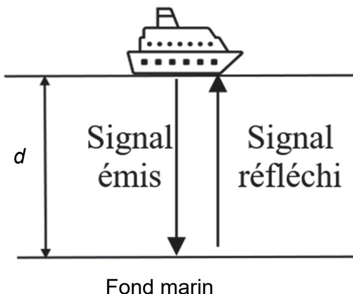
La profondeur d'un fond marin a été déterminée par un bateau équipé d'un sonar à partir de la durée  $T$  d'un aller-retour du signal sonore.
