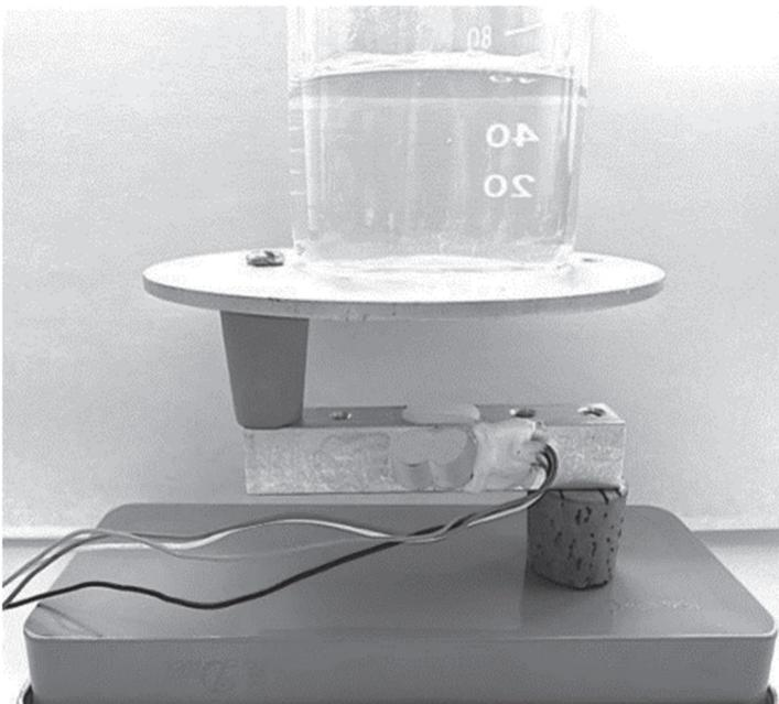
Le capteur est relié à un module (module HX711) qui permet de convertir et d'amplifier les signaux analogiques du capteur de masse en un signal numérique transféré au microcontrôleur.
