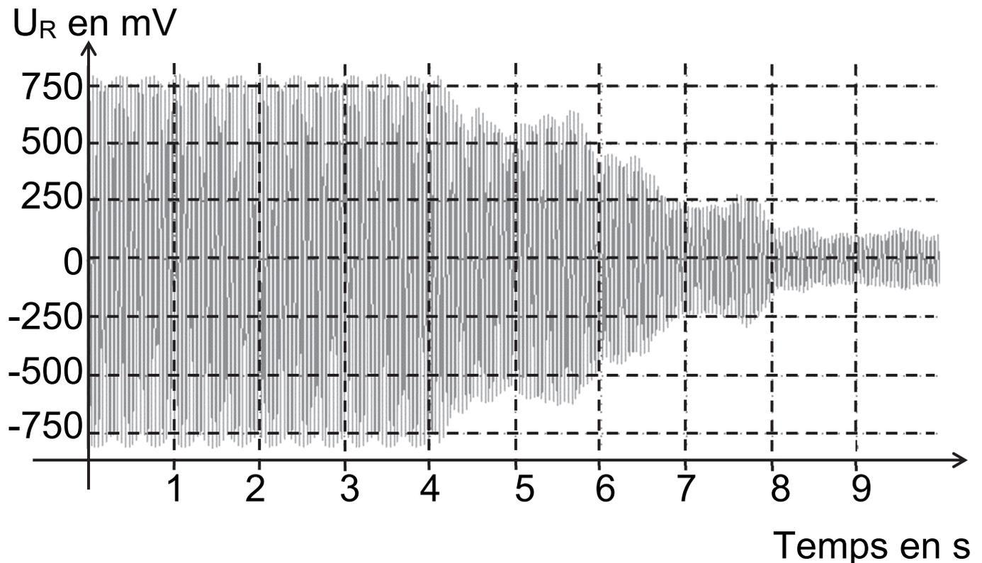
Lorsque la lame vibrante entre en contact avec le fluide, ses oscillations sont amorties.
