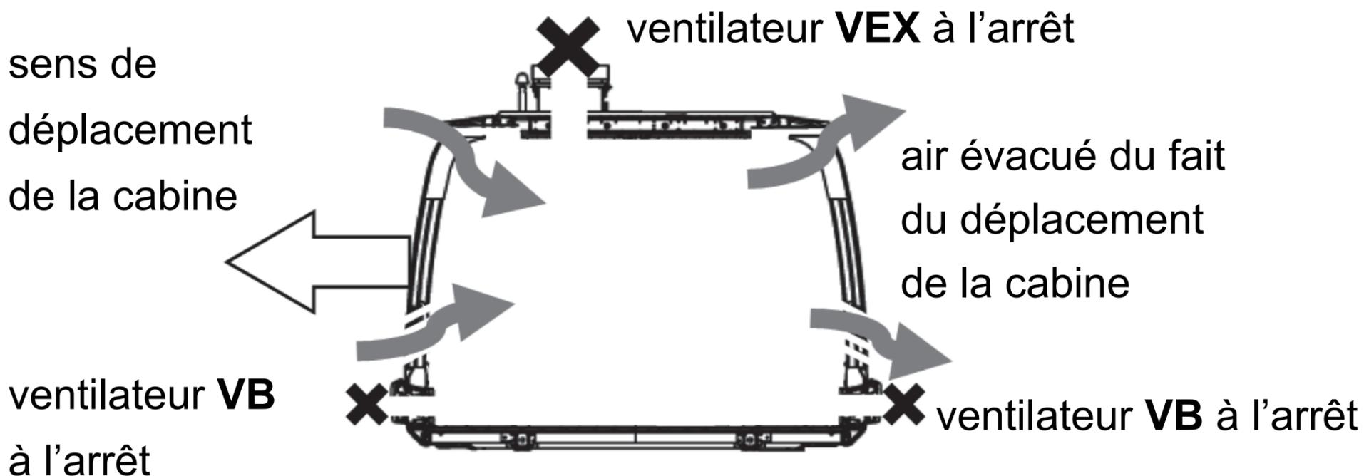
**Compléter** les zones en pointillés ci-dessous et page agrandie suivante en indiquant le sens des flux d'air.
