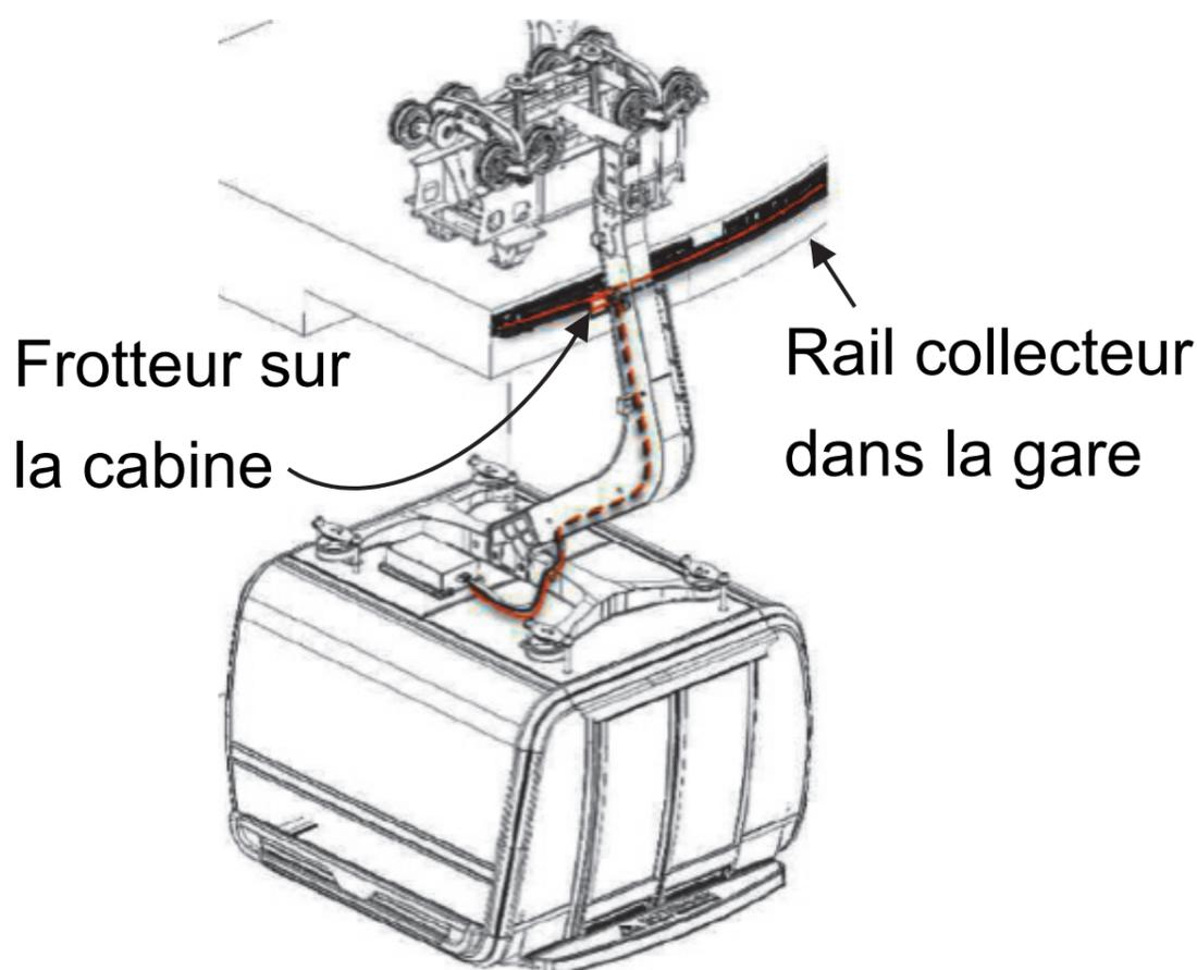
L'énergie consommée par la cabine est fournie par deux supercapacités qui se rechargent lors du passage en gare. Un frotteur entre en contact avec un rail collecteur et l'énergie électrique collectée en quelques dizaines de secondes doit permettre le fonctionnement autonome de la cabine jusqu'à la prochaine gare.
