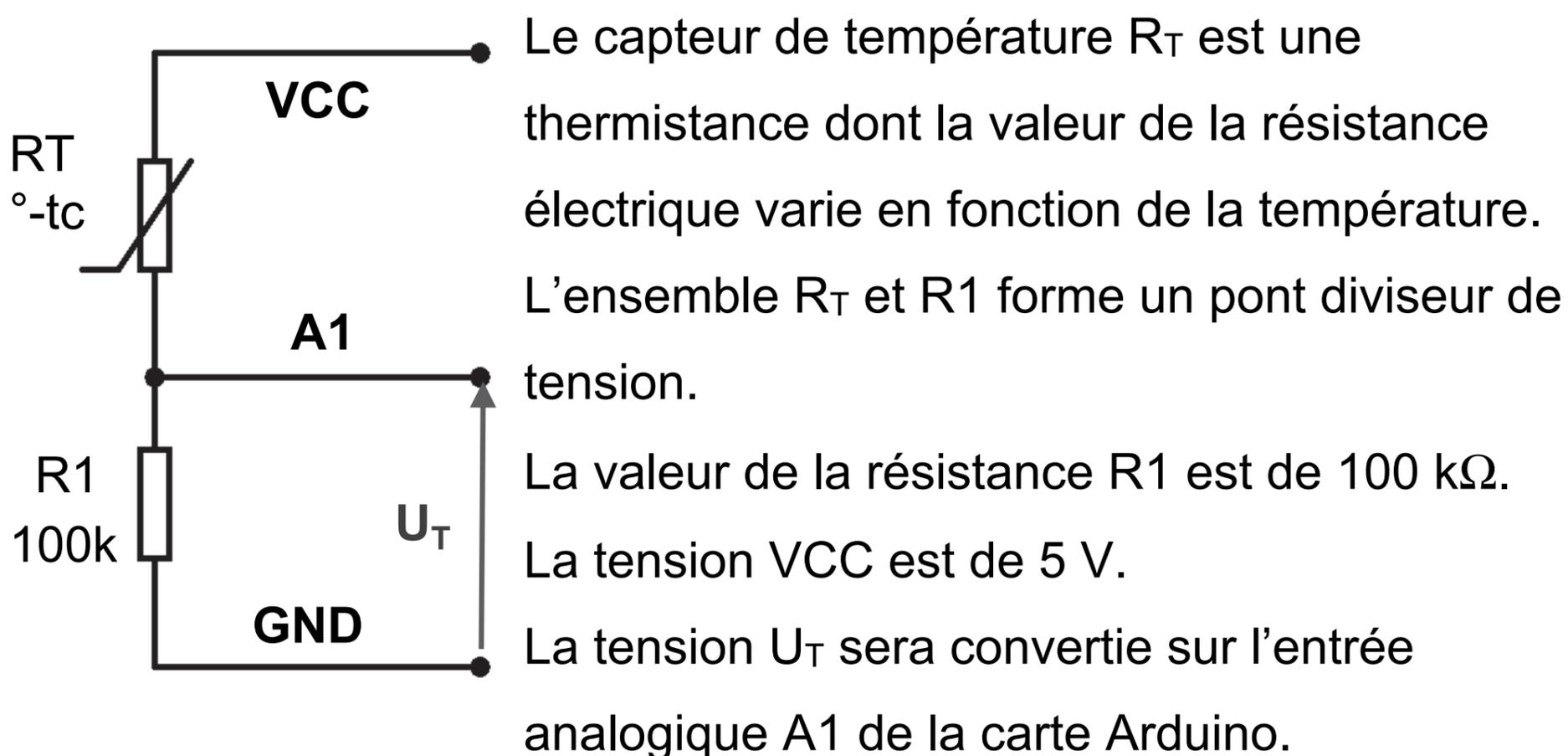
**Question C.4 – DTS9 ; DRS4 : Déterminer** la valeur de la résistance  $R_T$  pour une température de  $35^\circ\text{C}$  et l'**exprimer** en  $\text{k}\Omega$  sur DRS4.
