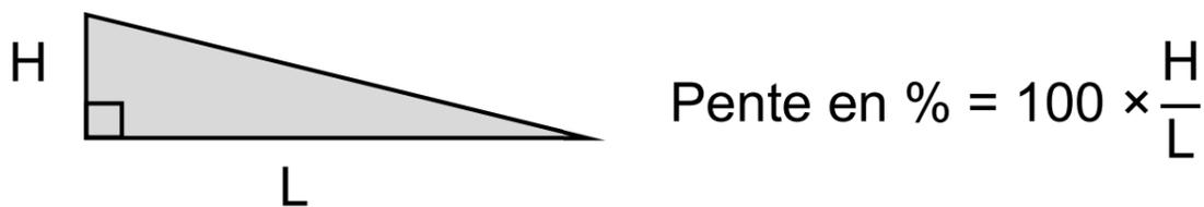
Lorsqu'une dénivellation ne peut être évitée, un plan incliné de pente inférieure ou égale à 6 % doit être aménagé afin de la franchir.
