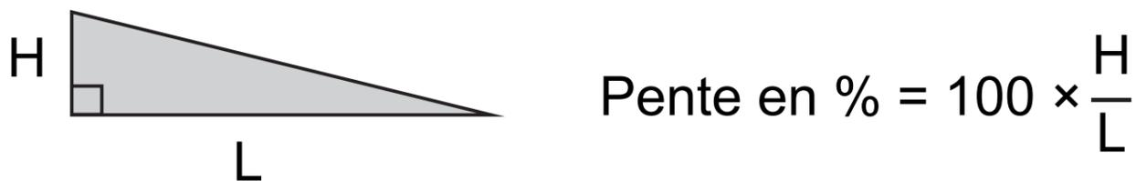
Lorsqu'une dénivellation ne peut être évitée, un plan incliné de pente inférieure ou égale à 6 % doit être aménagé afin de la franchir.
