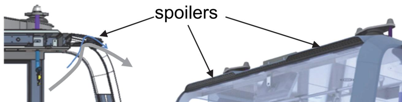
Le **spoiler** est un élément de carrosserie dont la forme a été étudiée pour canaliser le flux d'air. Il permet de diminuer les turbulences et d'améliorer le débit d'air.
