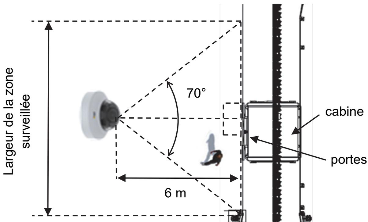
Quand une cabine se présente à la gare CHU, le quai est filmé par une caméra positionnée à une distance de 6 mètres face aux portes de la cabine. Son angle de vue horizontal est de  $70^\circ$ .
