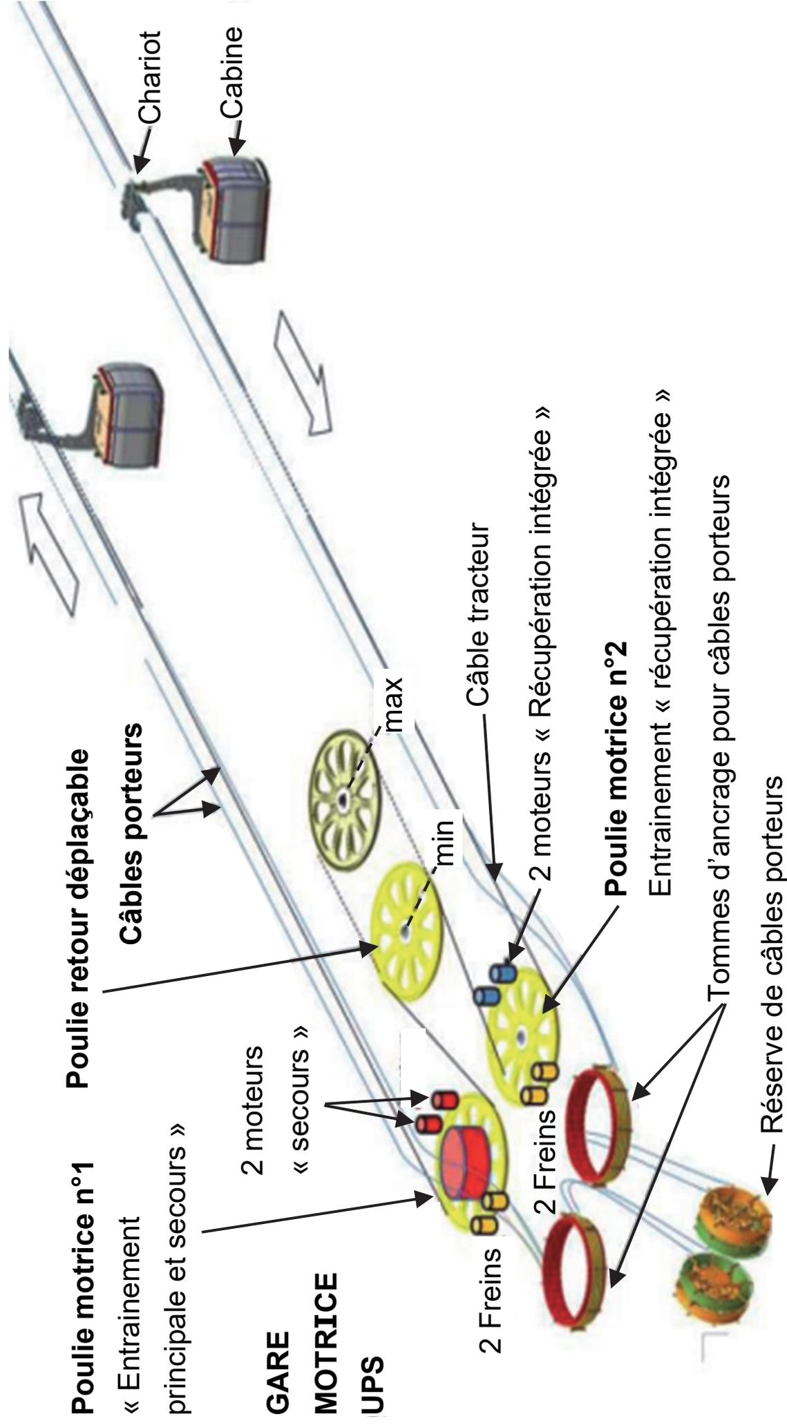
La poulie motrice qui entraîne le câble tracteur possède un diamètre de 4,55 mètres.
