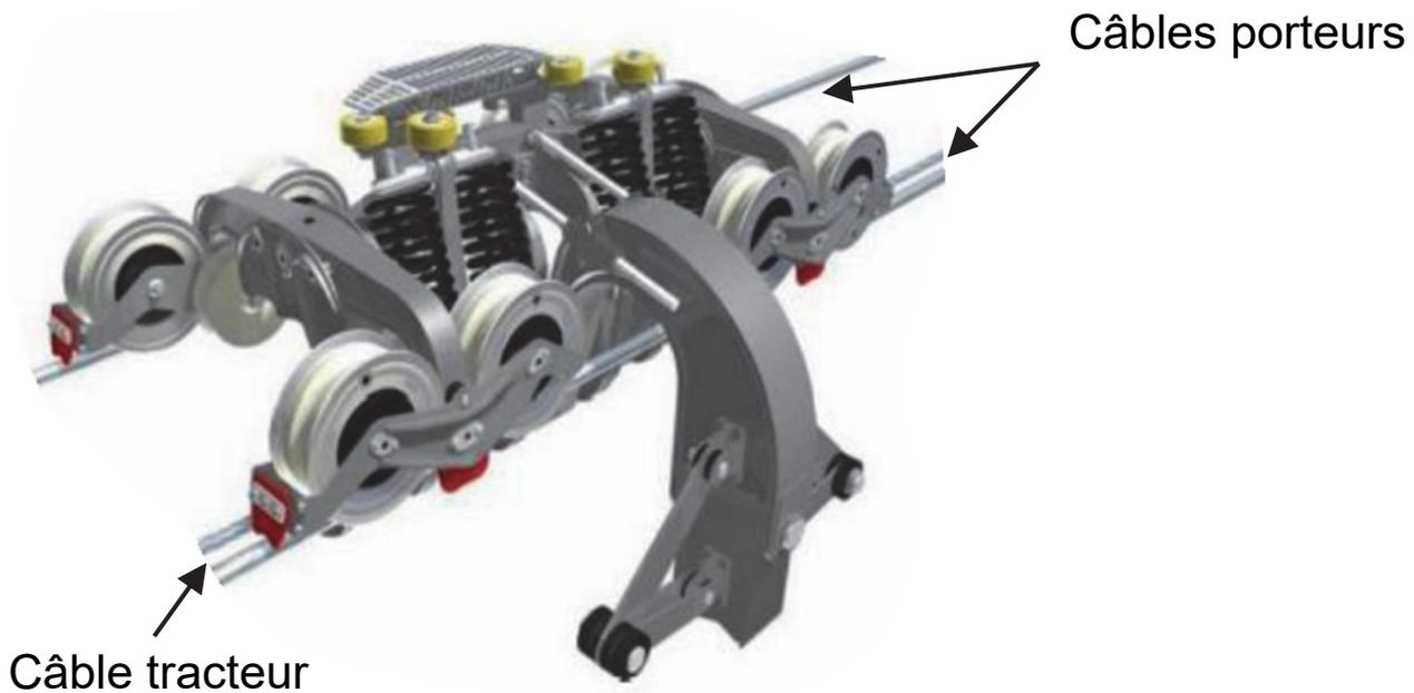
Le chariot est serré sur le câble tracteur par des pinces débrayables, alors que le roulement sur les câbles porteurs est assuré par huit galets porteurs.
