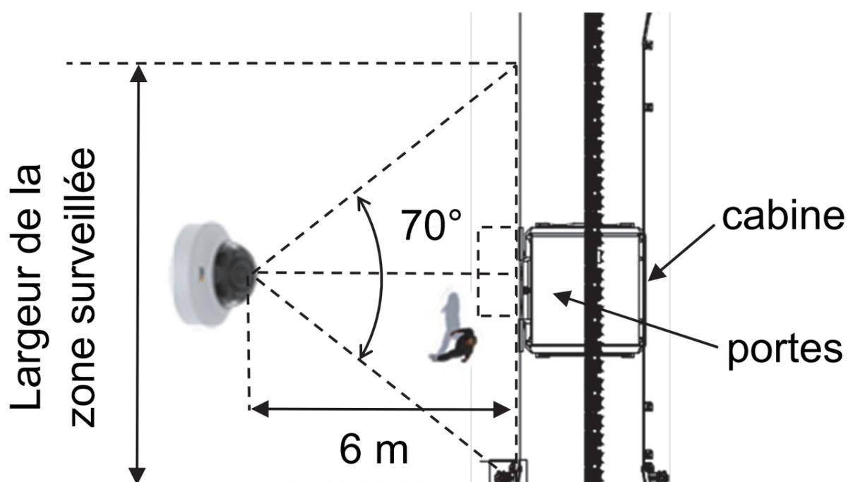
Quand une cabine se présente à la gare CHU, le quai est filmé par une caméra positionnée à une distance de 6 mètres face aux portes de la cabine. Son angle de vue horizontal est de  $70^\circ$ .
