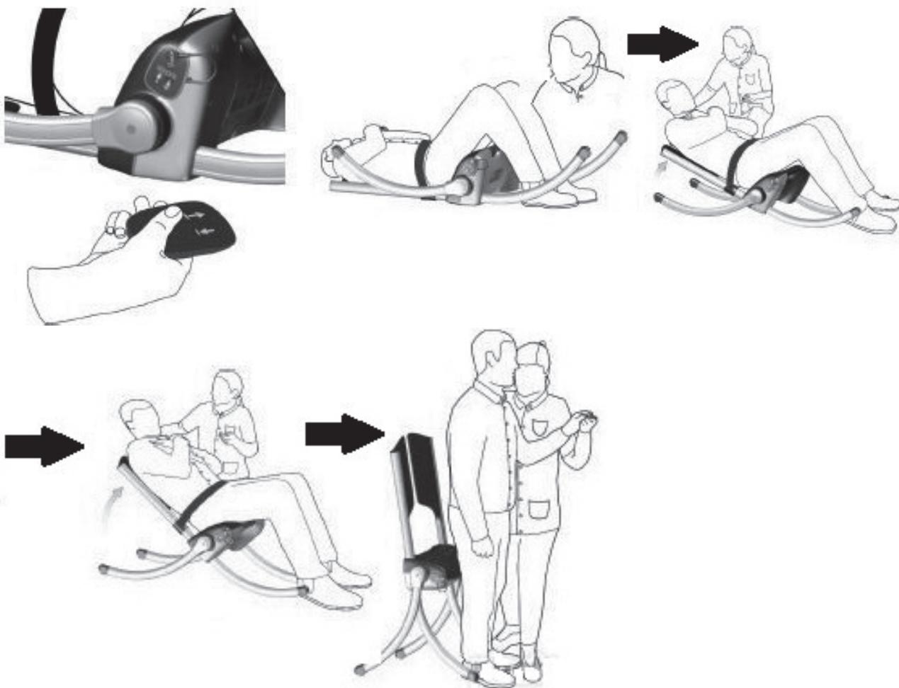
Sur le côté gauche de l'assise (figure 3 page agrandie suivante), se trouvent un bouton Marche/Arrêt, un bouton d'arrêt d'urgence, deux boutons déclenchant la montée et la descente du siège, ainsi que deux indicateurs (niveau de charge batterie et état de service). À chaque axe d'articulation des pieds arrières est disposé un voyant attestant du montage correct des éléments du système. La télécommande est rangée du côté droit de l'assise.
