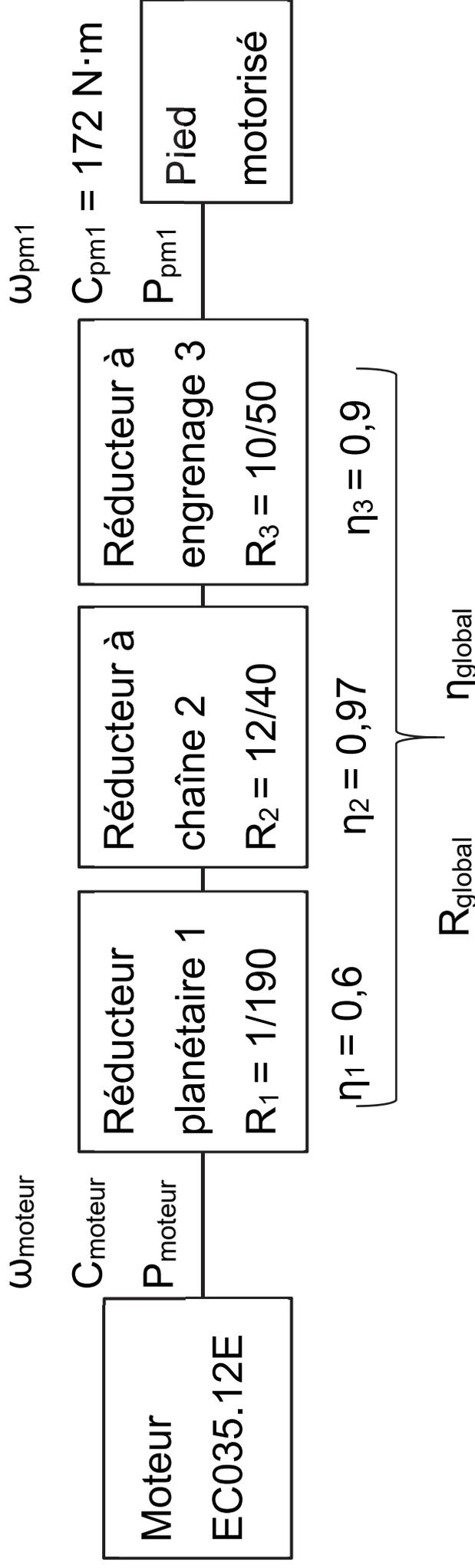
**Question 1.6 : Exprimer  $C_{\text{moteur}}$  en fonction de  $C_{\text{pm1}}$ ,  $\eta_{\text{global}}$  et  $R_{\text{global}}$ . Calculer la valeur du couple moteur  $C_{\text{moteur}}$  nécessaire pour relever la personne de 150 kg.**
