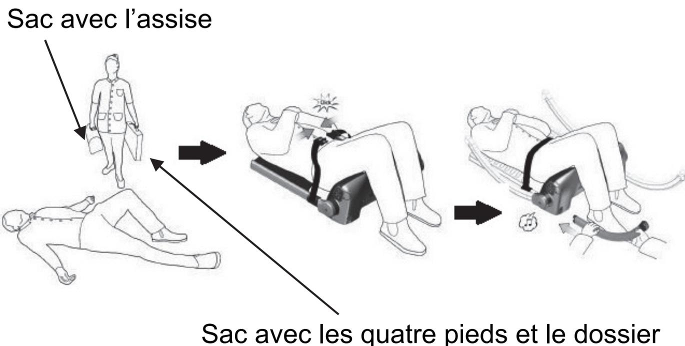
Le siège de relevage peut être activé dès qu'il est correctement assemblé et ne peut fonctionner que si les éléments sont parfaitement clipsés (figure 2). Le levage s'effectue électriquement. Il est commandé sur le siège ou à l'aide d'une télécommande. Il dure une trentaine de secondes environ. La batterie intégrée lui permet d'être autonome et facilite l'intervention en tout lieu.
