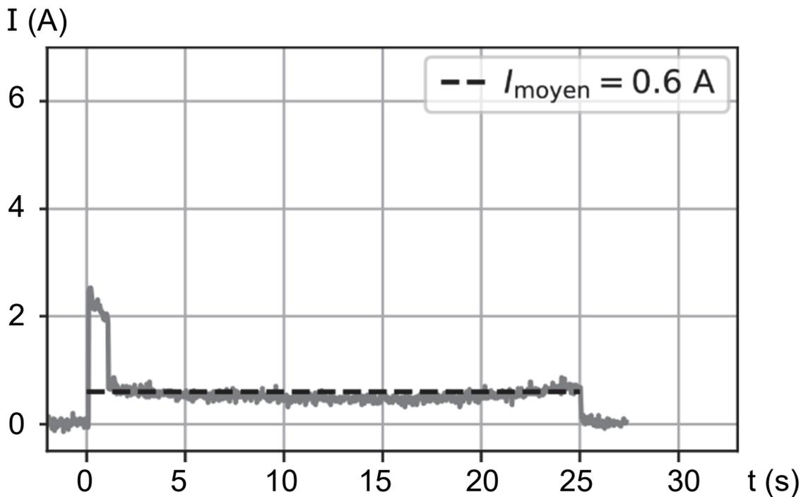
Le siège de relevage est équipé de deux ensembles motoréducteurs qui entraînent chacun un pied motorisé (le courant absorbé par la carte de commande est négligé).
