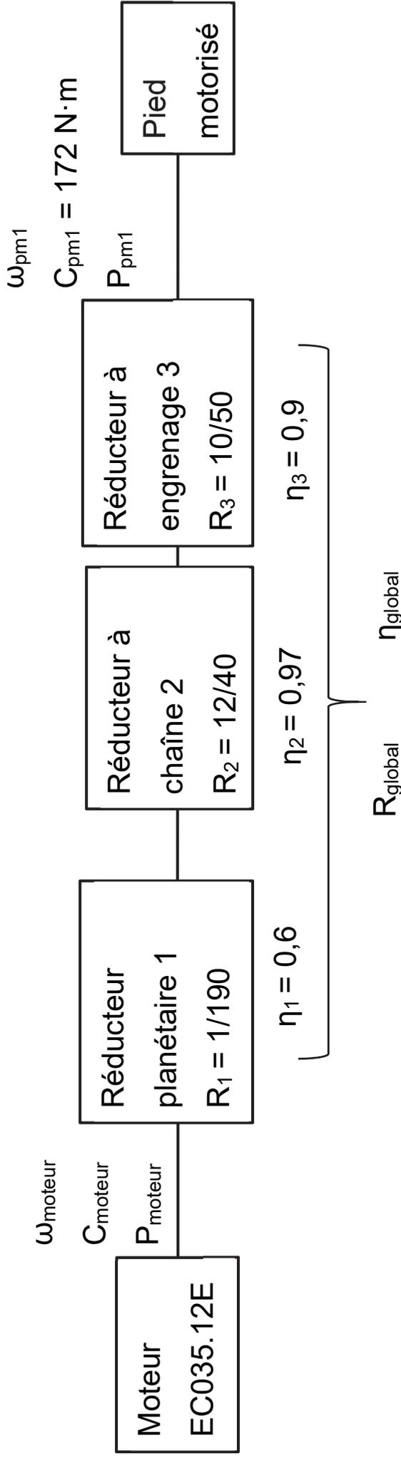
**Question 1.6 : Exprimer  $C_{\text{moteur}}$  en fonction de  $C_{\text{pm1}}$ ,  $\eta_{\text{global}}$  et  $R_{\text{global}}$ . Calculer la valeur du couple moteur**
