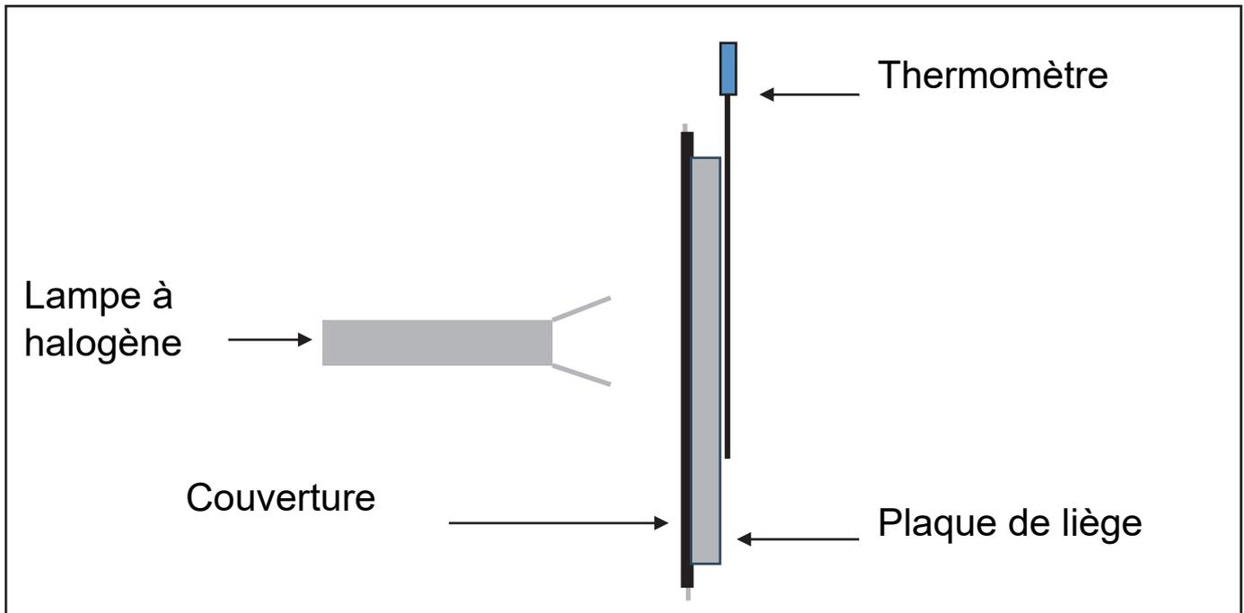
Figure 2 : schéma du dispositif expérimental
