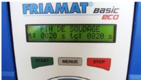
10 La durée de la soudure est déterminée par l'appareil. Ne pas toucher pendant la soudure. La fin de la soudure est signalée par un signal sonore
