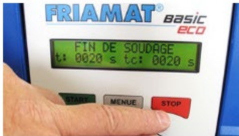
11 La soudure est terminée. Pressez le bouton Stop. Retirez les têtes de soudure. Marquer l'heure de fin de refroidissement sur la pièce : heure de fin de soudure + temps indiqué à l'écran.
