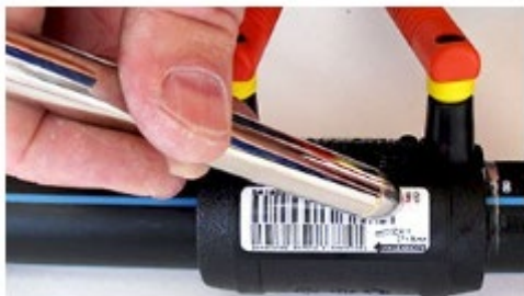
8 Lire le code barre : -avec le stylo en effectuant un aller-retour rapidement de gauche à droite sans le décoller de l'étiquette et en débordant de celle-ci. -avec la scanette en fonction de l'appareil
