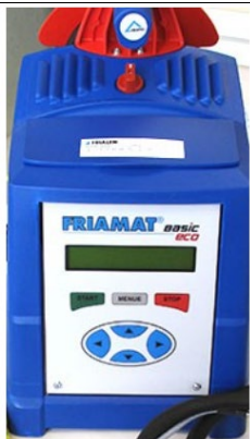
6 Allumer l'automate de soudage
