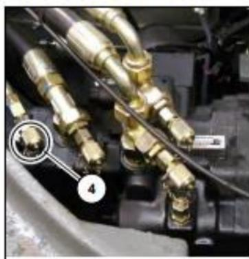
Fig. 42: Raccord de mesure de la pression de pilotage
