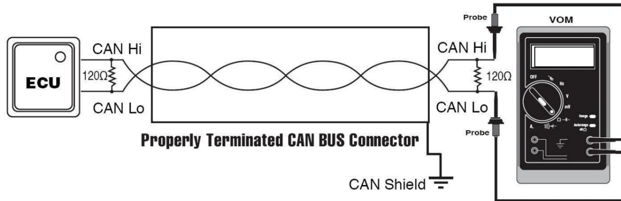
**B.3.5 :** Quelle valeur doit on lire sur le multimètre (fig.ci-dessus) ? Justifier par un calcul.
