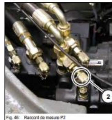
Fig. 46: Raccord de mesure P2
