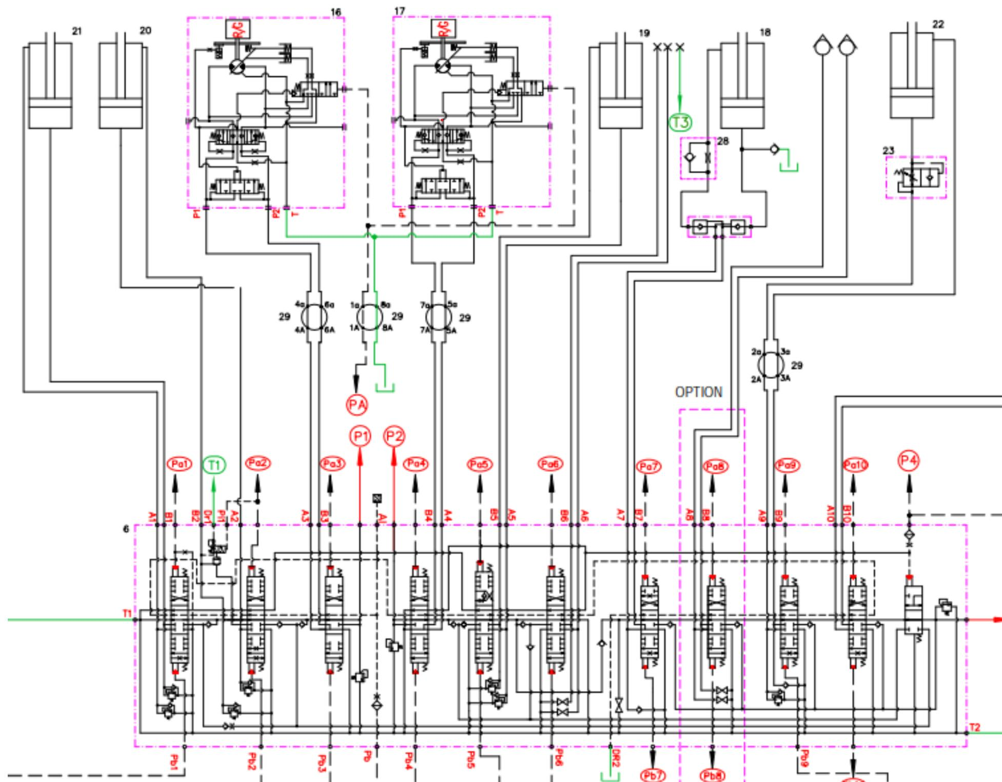
C1.11 : Sur le schéma ci-dessous du distributeur lorsqu'il est piloté en marche avant, tracer en rouge la haute pression et en bleu la basse pression.
