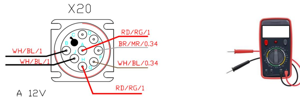
Compléter le tableau du contrôle de la tension de CAN H
