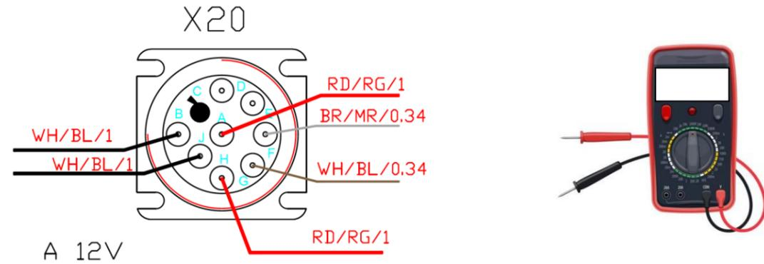
Compléter le tableau du contrôle de la tension de CAN L
