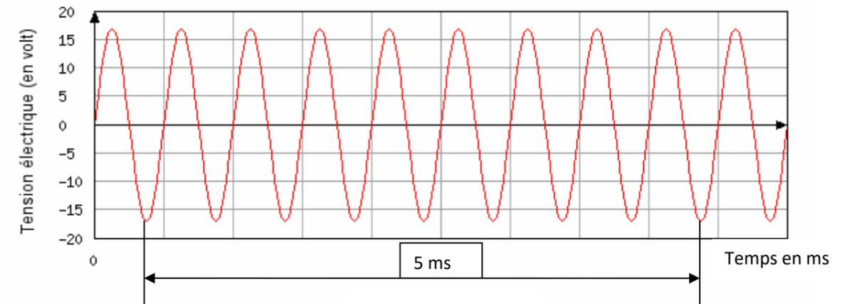
B.4.11.1 : Calculer la fréquence du signal émis par le capteur (détaillez vos calculs) :
