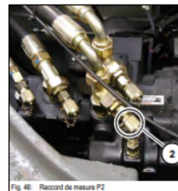
Fig. 46: Raccord de mesure P2
