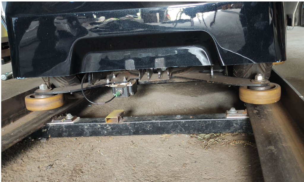
Solution actuelle de guidage de la capsule
