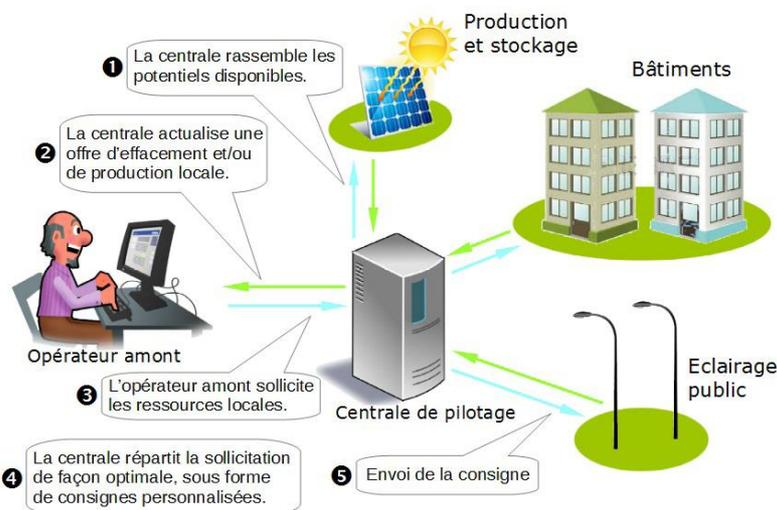
Le **micro grid** est un **réseau électrique intelligent** à plus petite échelle qu'un smart grid, mais il comporte tout de même des installations de production, de consommation, de stockage et des outils pour gérer la demande. Il peut être mis en place à l'échelle d'un bâtiment, d'un quartier, d'un campus, d'un village et même d'une zone industrielle ou artisanale. Il permet de fournir des services plus personnalisés ainsi qu'un
