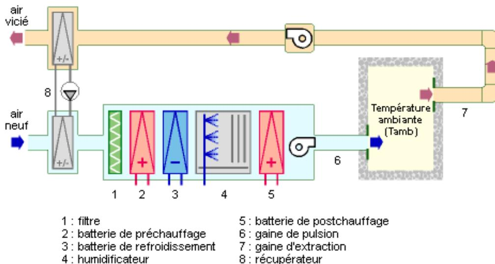
Schéma de principe d'une centrale de traitement de l'air
