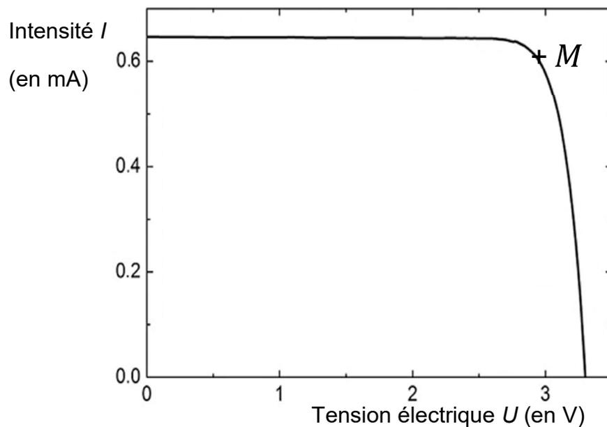
Le point M sur la courbe de la caractéristique de la cellule photovoltaïque est le point de fonctionnement correspondant à la valeur maximale de la puissance électrique fournie par la cellule pour un éclairement imposé de  $1000 \text{ W}\cdot\text{m}^{-2}$ .
