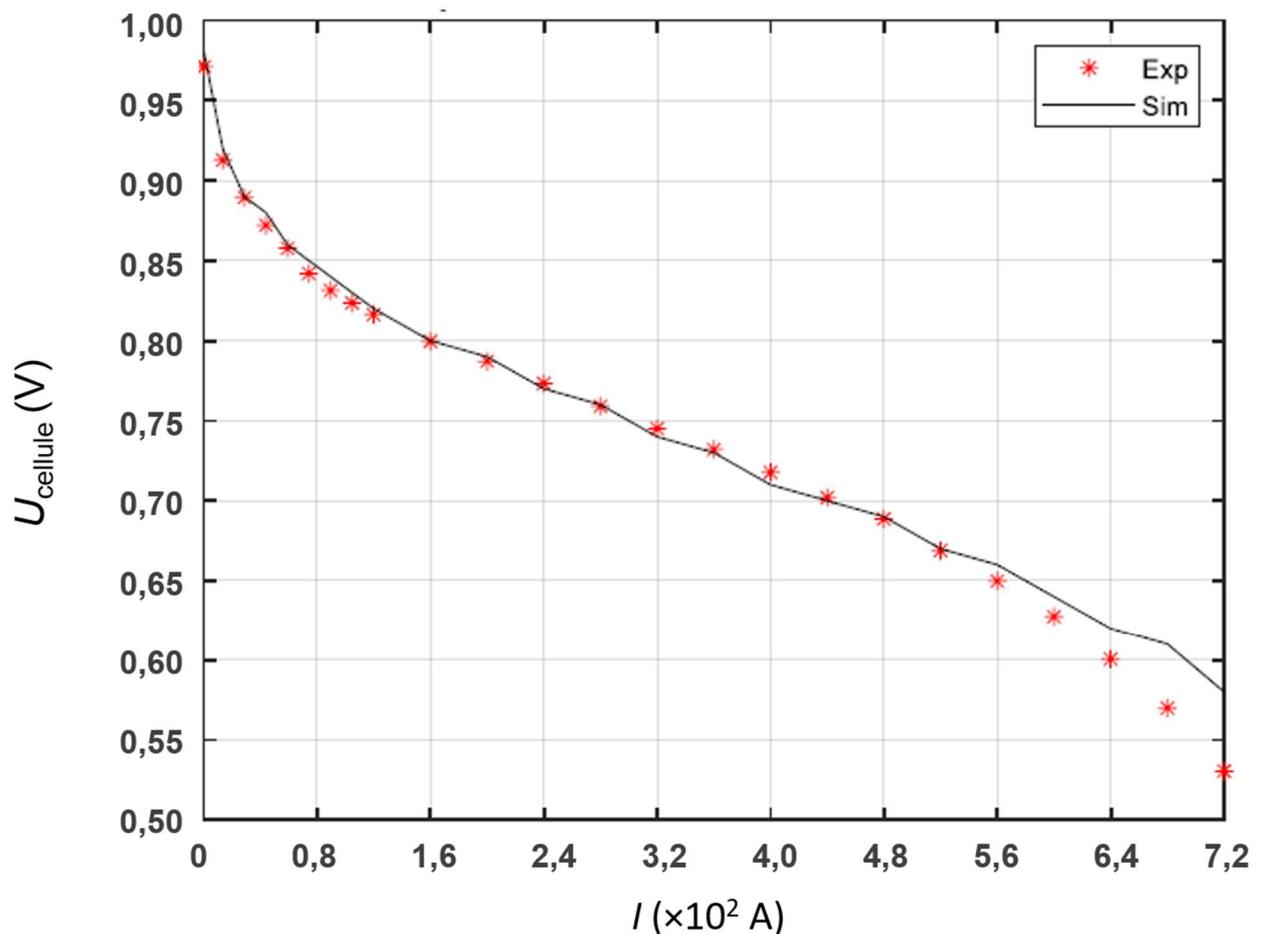
**Courbe caractéristique d'une cellule élémentaire de la pile PEMFC**
