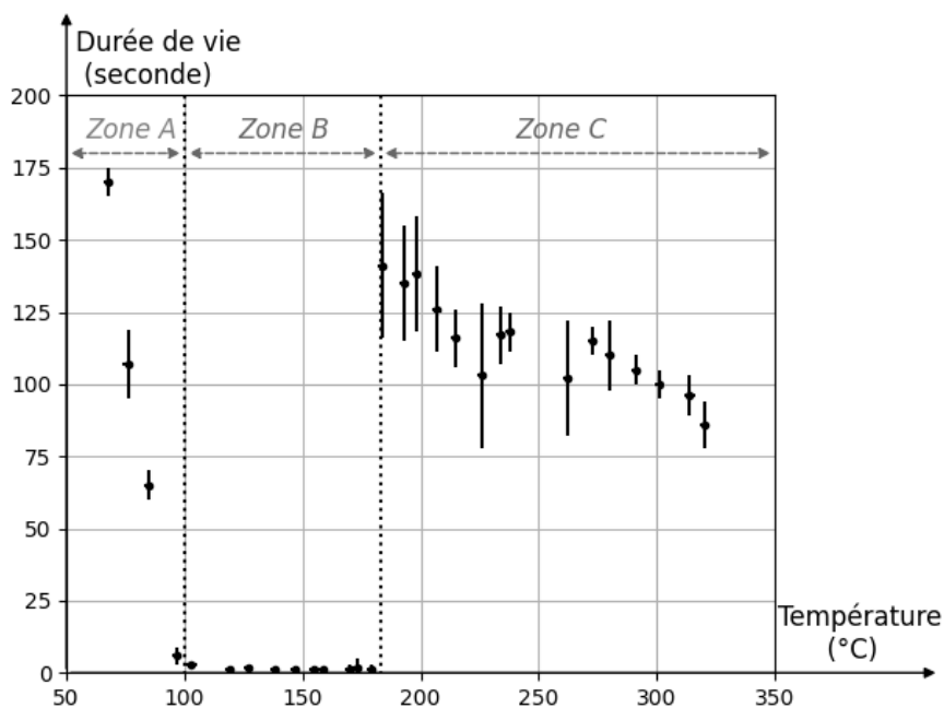
Figure 2. Durée de vie d'une goutte de 50 \mu\text{L} en fonction de la température de la plaque.
