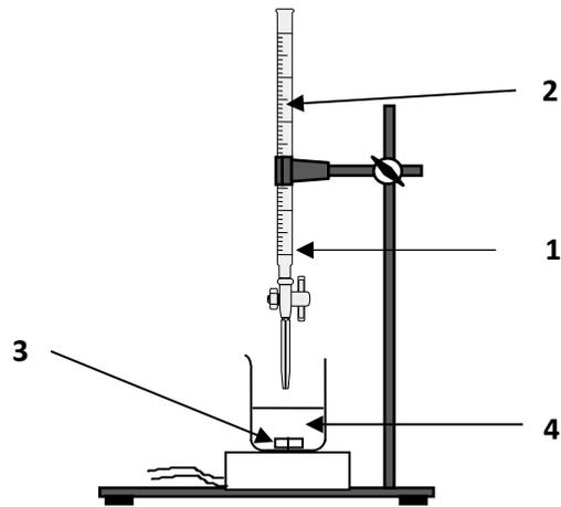
Figure 3 : schéma du dispositif expérimental du titrage
