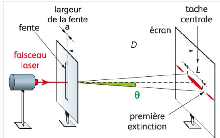
Figure 1 : montage de diffraction
