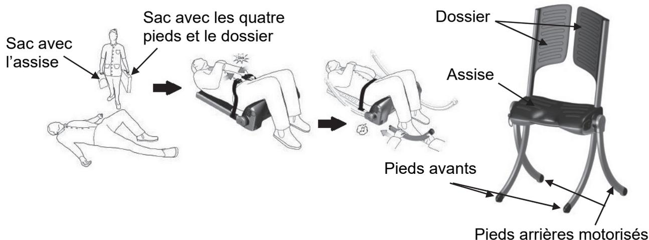
Figure 1 : assemblage du siège de relevage
