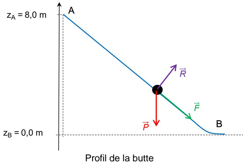
Pendant cette descente, on considère que le système {pilote + bicyclette}, assimilé à un point matériel de masse totale  $m = 93 \text{ kg}$  se déplace de la position A jusqu'à la position B, en n'étant soumis qu'à trois actions mécaniques modélisées par son poids  $\vec{P}$ , la réaction  $\vec{R}$  du plan incliné toujours perpendiculaire au plan et la force motrice  $\vec{F}$  de norme supposée constante et parallèle au plan. Le référentiel terrestre est ici considéré comme galiléen.
