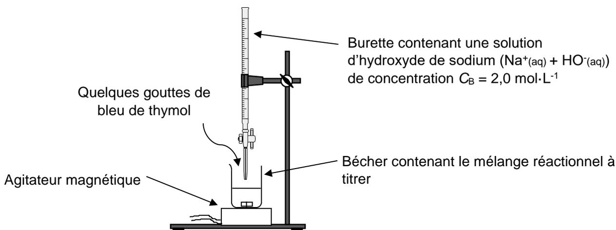
Schéma du dispositif expérimental du titrage
