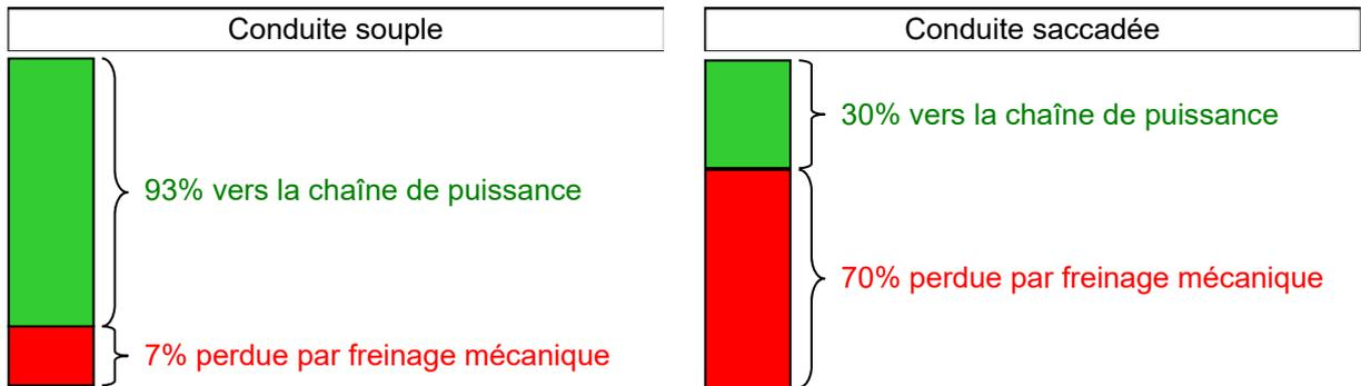
En récupération d'énergie, le rendement global de la chaîne de puissance est estimé à  $\eta_{global} = 78\%$ .
