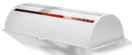
Le connecteur est fixé sur le toit du bus (4 kg).
