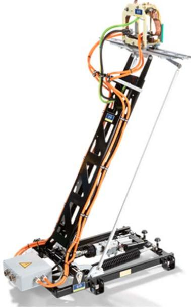
Chaque bus est doté d'un pantographe (coût d'installation plus important).
