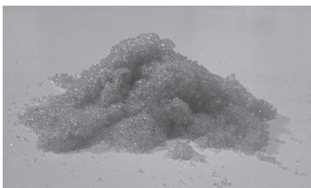
Microbilles de résine échangeuse d'ions (Source : Wikipédia).
