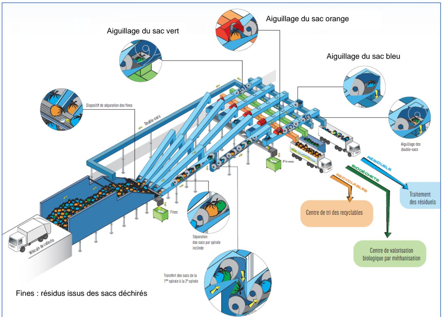
Les sacs sont déversés par les véhicules de collecte dans une fosse munie d'un système permettant de les faire avancer vers les 5 lignes de tri. Celles-ci sont pourvues de convoyeurs à vis d'Archimède pour déplacer les sacs. Un système de reconnaissance optique permet d'aiguiller les différents sacs en fonction de leurs couleurs. Les éventuels double-sacs sont réinjectés dans la fosse.
