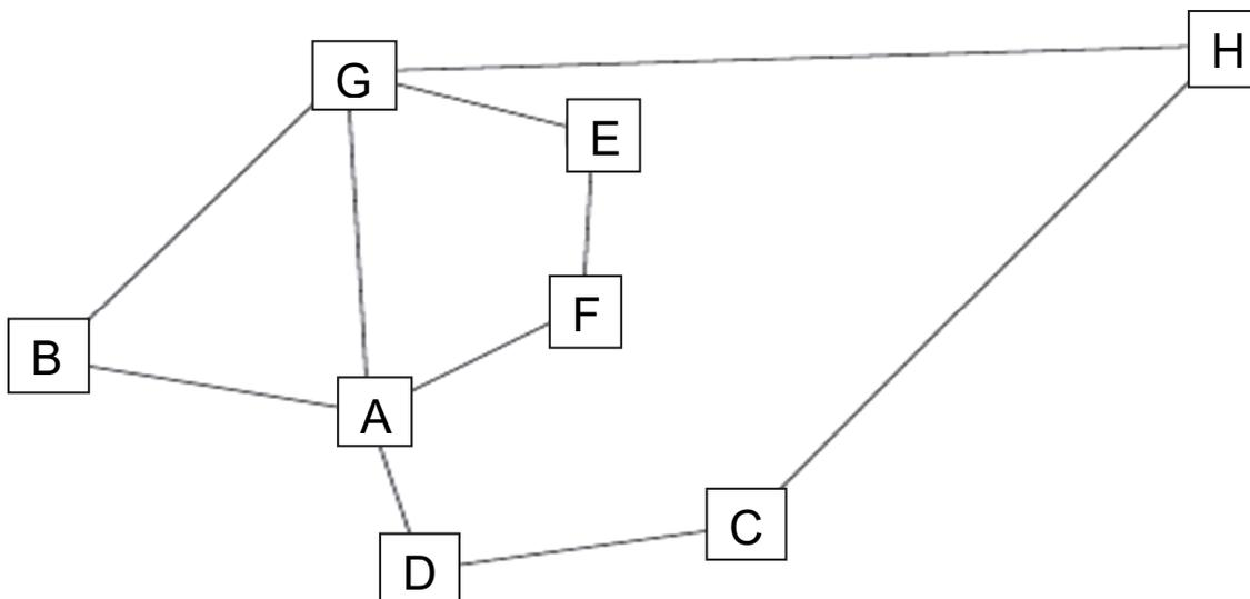
On s'intéresse au protocole RIP, qui minimise le nombre de sauts entre routeurs. Si on l'applique au nœud A de la figure 2, on obtient la table de coûts suivante :
