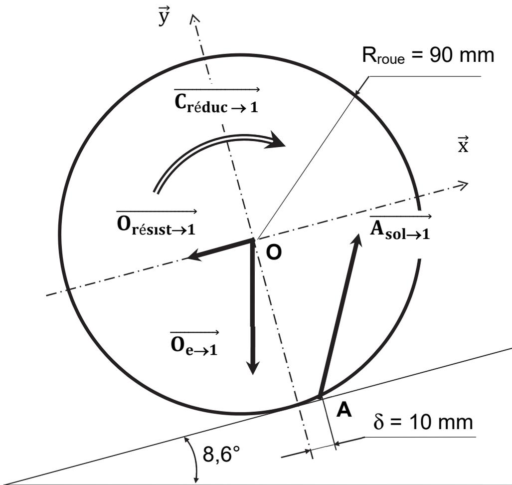
•  $\vec{C}_{reduc \rightarrow 1}$ , couple appliqué sur l'axe de la roue
