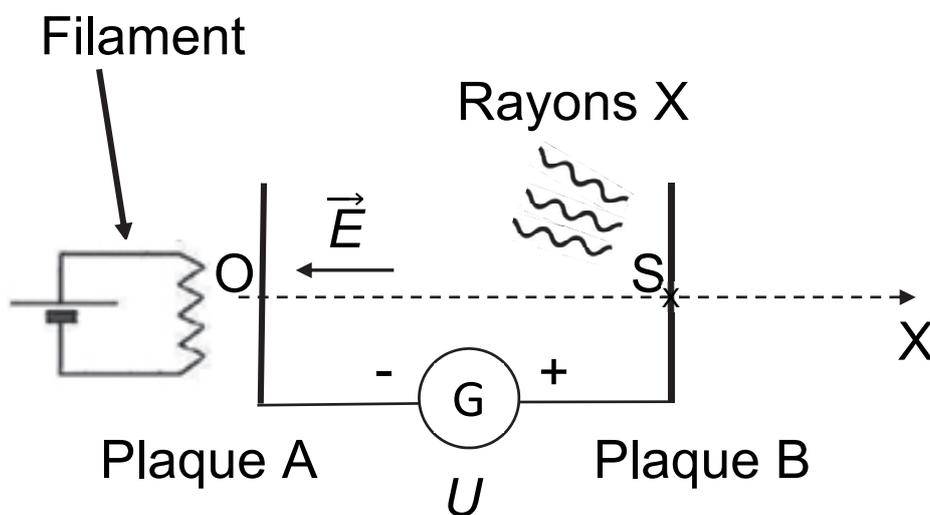
Dans la suite de l'exercice, on s'intéresse à un électron issu du point O sans vitesse initiale et accéléré jusqu'au point S de la plaque B.
