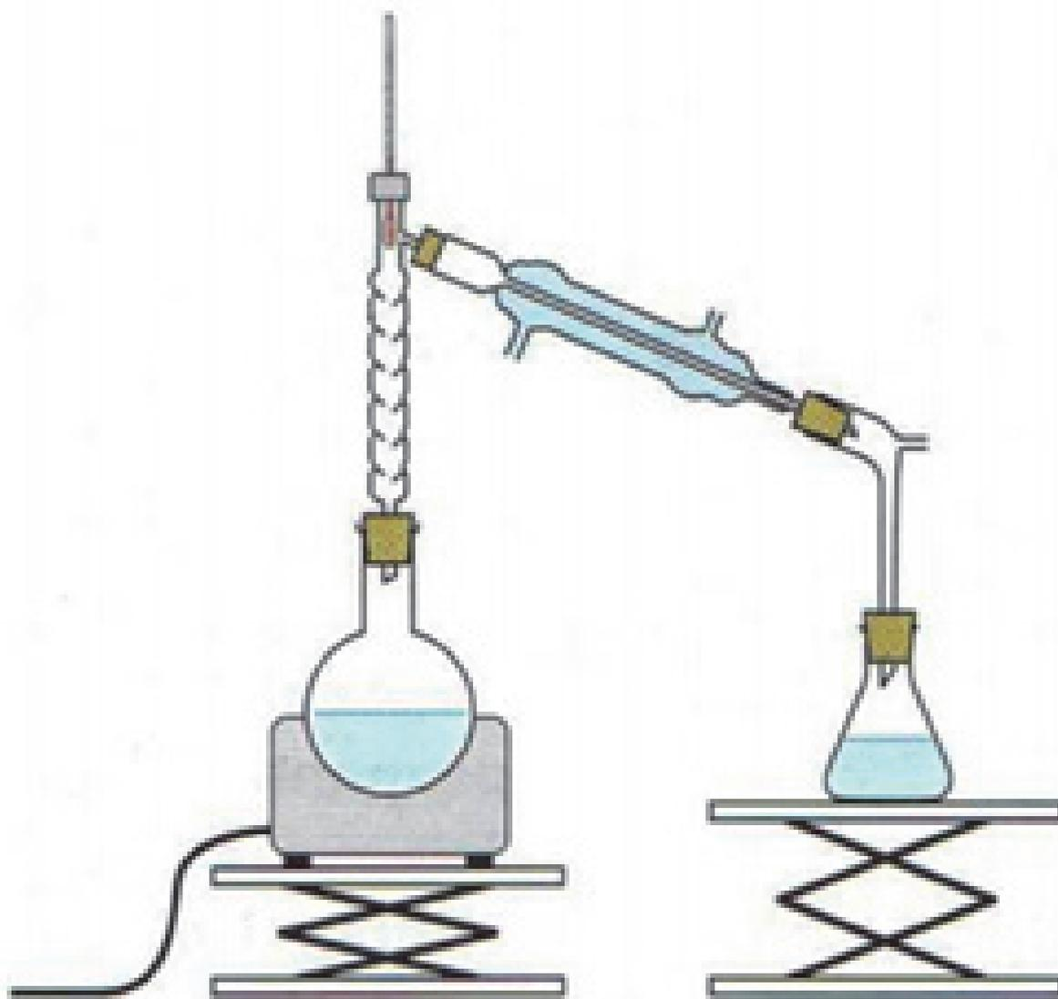
**Q11.** À l'aide des températures d'ébullition fournies dans le tableau de données, expliquer en quoi le montage de distillation fractionnée permet d'optimiser le rendement de la synthèse du méthanoate d'éthyle.
