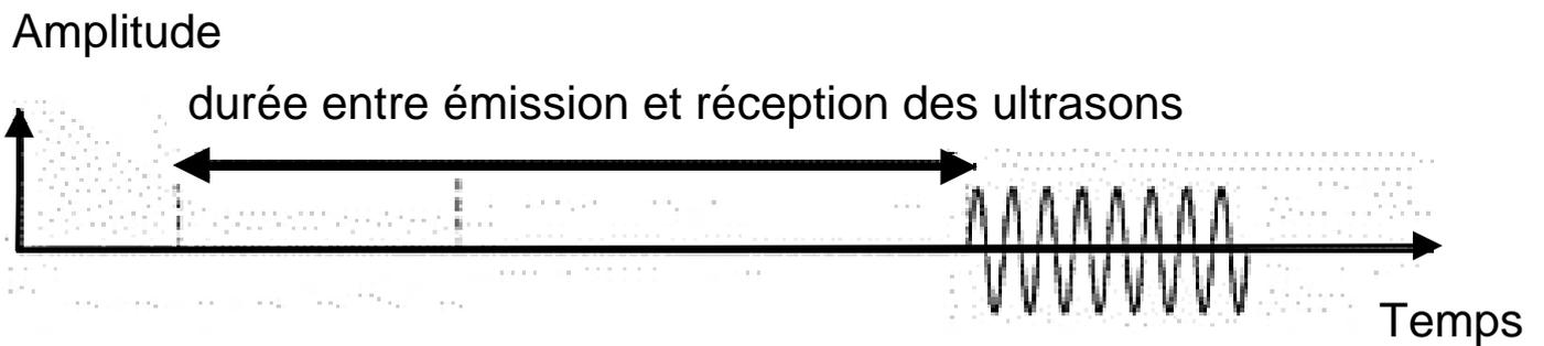
Une modélisation au laboratoire du capteur, à l'aide d'un émetteur et d'un récepteur à ultrasons indépendants, a permis d'obtenir la copie d'écran d'oscilloscope suivante dans le cas d'un obstacle situé à une distance de 10 cm.
