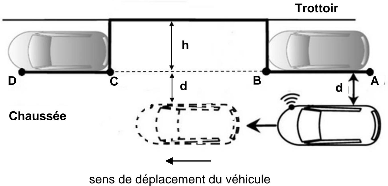
On a réalisé un dispositif modélisant ce système grâce à un microcontrôleur et un émetteur-récepteur à ultrasons que l'on a fixé sur une voiture se déplaçant comme indiqué sur le document 5.
