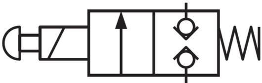
Distributeur 2/2 NF monostable à commande électrique et manuelle.
