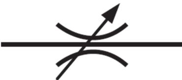
Il régule le débit du fluide pour contrôler la vitesse de déplacement du piston du vérin.
