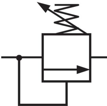
Limite la pression dans le circuit fluide.
