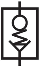
Ce clapet, monté à proximité du vérin hydraulique, provoque le blocage de celui-ci dès l'augmentation instantanée de débit résultant, par exemple, d'une rupture de tuyauterie.
