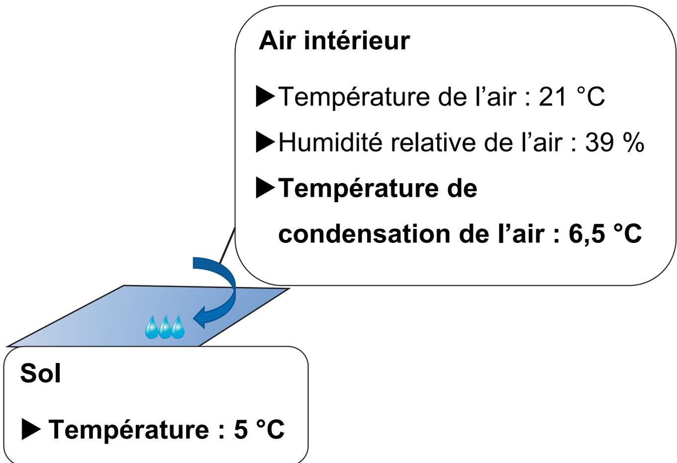
**Si Température du sol < Température de condensation de l'air**
