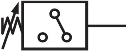
Détecteur permettant d'arrêter le moteur électrique de la pompe hydraulique lorsque la pression voulue est atteinte.
