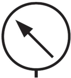
Instrument de mesure permettant de visualiser la pression en temps réel dans le circuit fluide.
