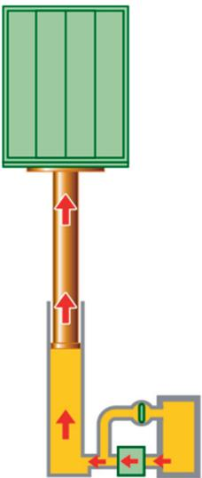
Contrairement à l'ascenseur électrique, il ne dispose pas de contrepoids, car la cabine est propulsée grâce à un système de vérin.
