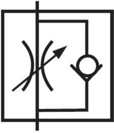
Il régule le débit du fluide pour contrôler la vitesse de déplacement du piston du vérin uniquement dans une direction.
