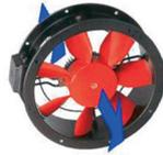
Dans ce type de ventilateur, l'air est aspiré et refoulé axialement. Ces ventilateurs ne permettent pas de générer des pressions très élevées, mais ils peuvent en revanche
