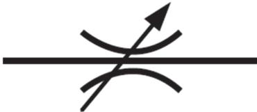
Il règle le débit du fluide pour contrôler la vitesse de déplacement du piston du vérin.
