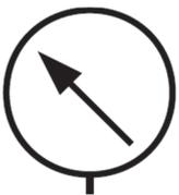
Instrument de mesure permettant de visualiser la pression en temps réel dans le circuit fluidique.
