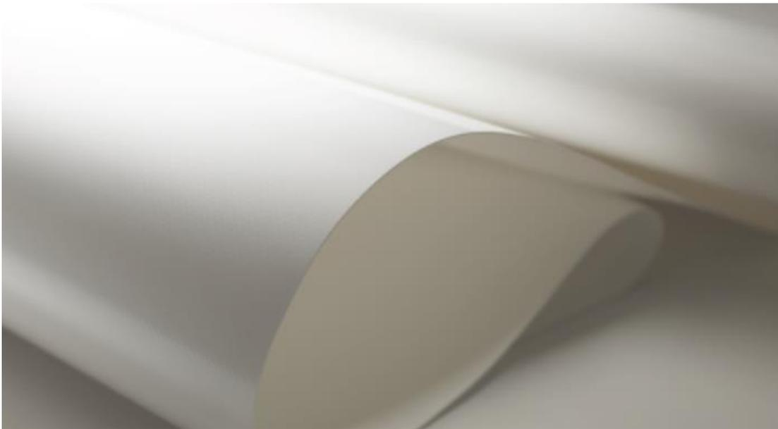
Les deux membranes extérieures et intérieures sont constituées d'un tissu en fibres de polyester renforcé par un enduit PVC.
