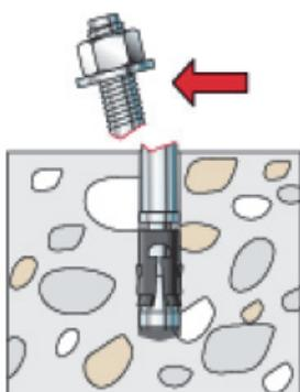
Cas C : Rupture par cône de béton en traction
