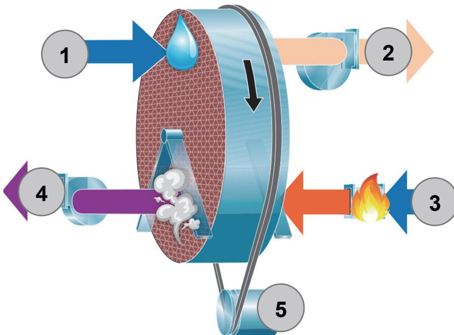
**Étape 1** : de l'air est pris de l'extérieur, son humidité se dépose sur la roue.
