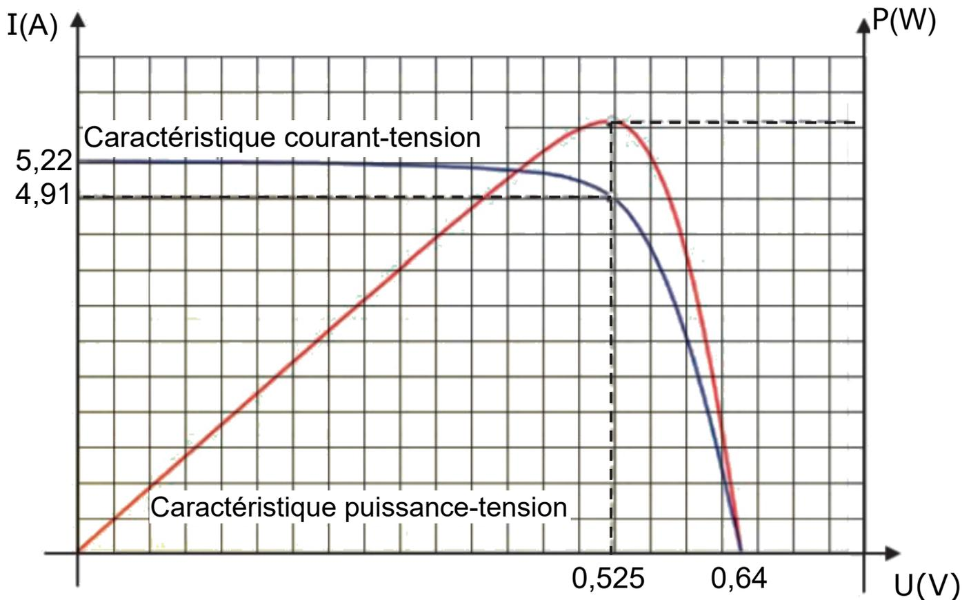
**Caractéristiques électrique d'une cellule photovoltaïque
