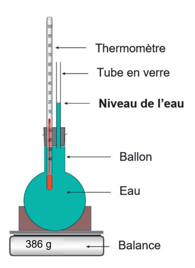
De l'eau, initialement placée dans un réfrigérateur à une température de 5°C, est mise dans un ballon surmonté d'un bouchon, d'un thermomètre et d'un tube en verre. Le niveau de l'eau dans le tube est indiqué sur le schéma page précédente.
