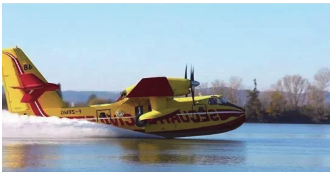
Figure 4 – Avion bombardier d'eau remplissant ses réservoirs d'eau.
