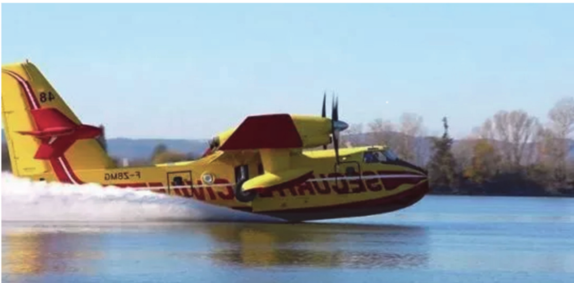
Figure 4 – Avion bombardier d'eau remplissant ses réservoirs d'eau.
