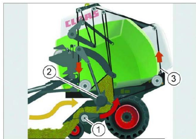
La matière ramassée par le pick-up (1) passe sous le rotor (2) où elle est éventuellement coupée (rotocut) si l'opérateur sort les couteaux.
