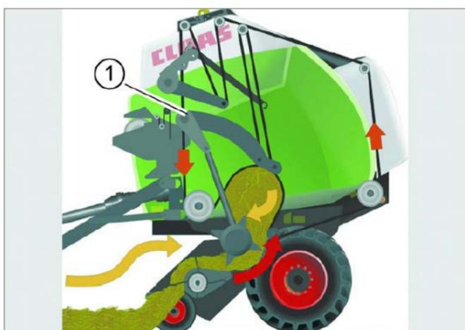
La compression de la matière en rotation dans la chambre induit un déplacement continu et régulier du bras de tension inférieur (1) vers le haut.
