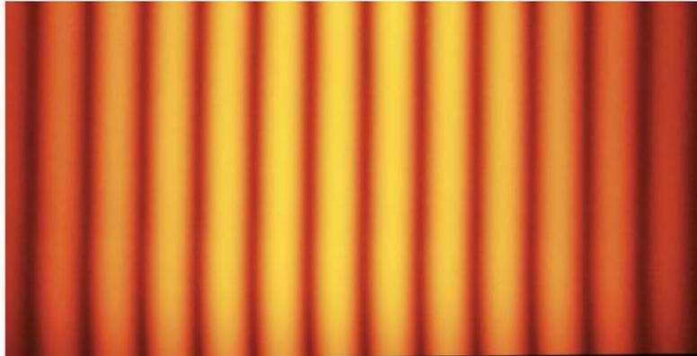
Franges obtenues avec deux fentes éclairées par une lampe à vapeur de sodium<sup>10</sup>
