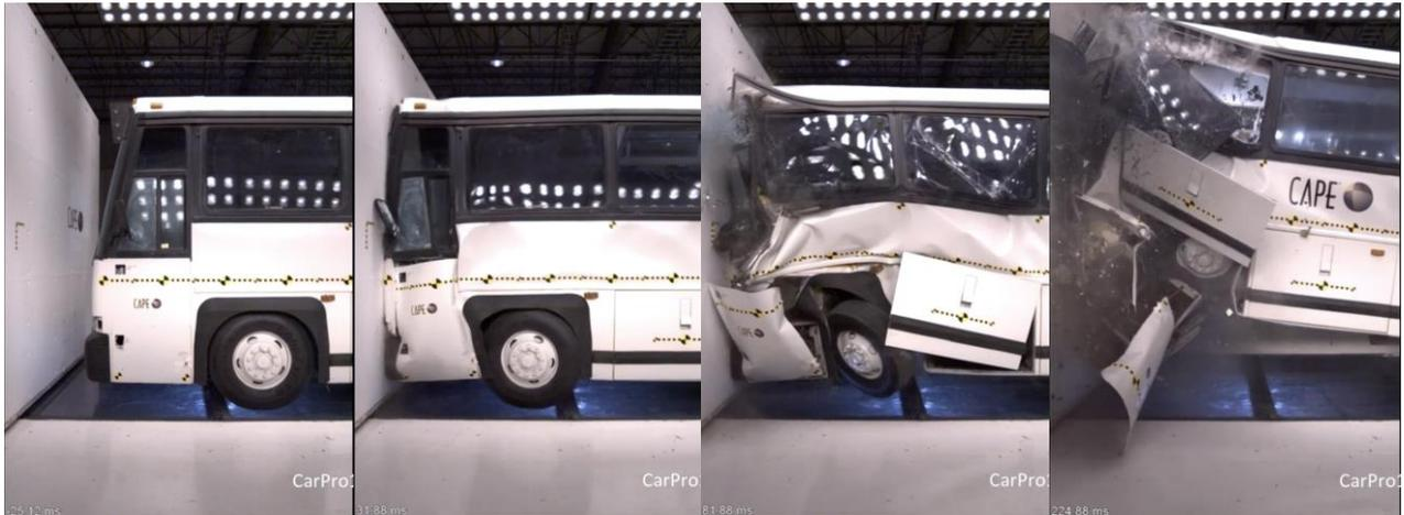
L'enregistrement vidéo<sup>15</sup> de ce crash test d'un bus propulsé à une vitesse constante sur une route rectiligne horizontale, montre qu'entre le début et la fin du choc, la décélération  $a$  du bus passe rapidement d'une valeur nulle à une valeur maximale très élevée avant de diminuer brutalement puis augmenter à nouveau plus lentement avant de s'annuler en fin de choc.
