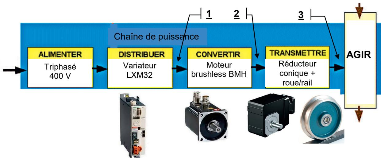
Figure 15 : chaîne de puissance axe  $\vec{X}$ .
