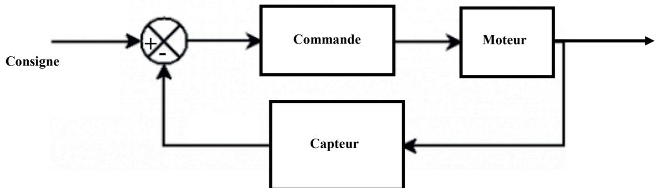
Figure 14 : schéma de la commande de l'axe X.
