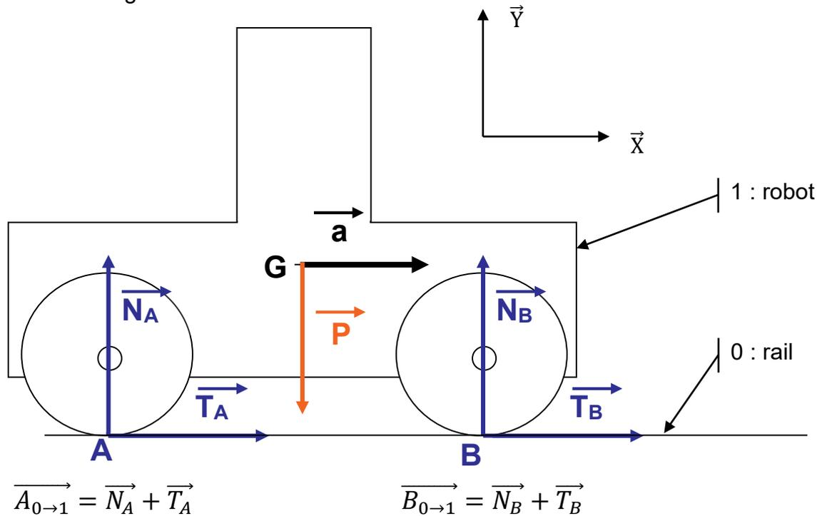
Figure 18 : modélisation du robot en phase d'accélération.
