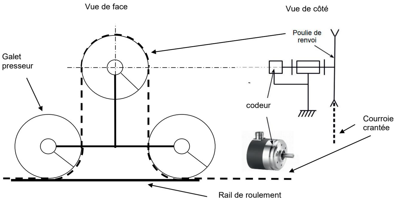
Figure 13 : implantation du codeur absolu multi-tours.
