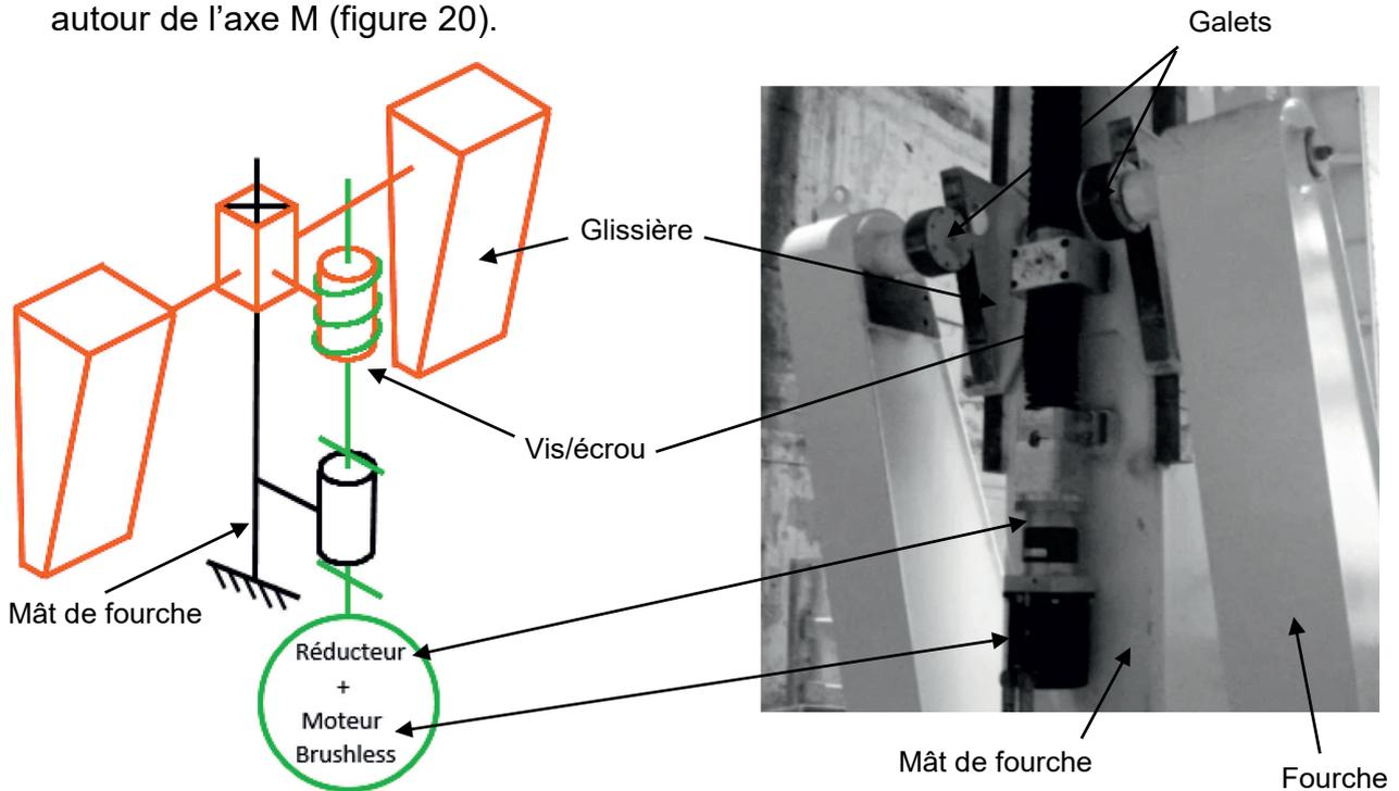
Figure 19 : schématisation de la chaîne d'énergie du matage.
