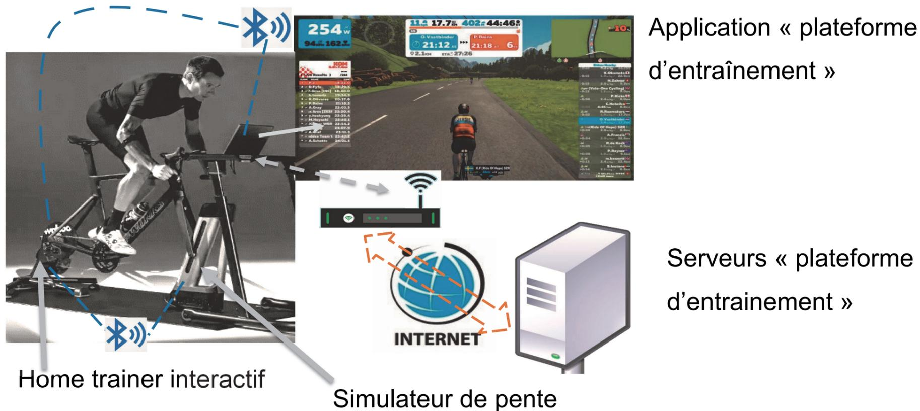
Le simulateur de pente possède deux modes de fonctionnement (manuel ou piloté). En mode manuel, au moyen d'un boîtier (figure 5) fixé sur le guidon, le cycliste peut augmenter ou diminuer l'inclinaison à l'aide de deux boutons poussoirs.
