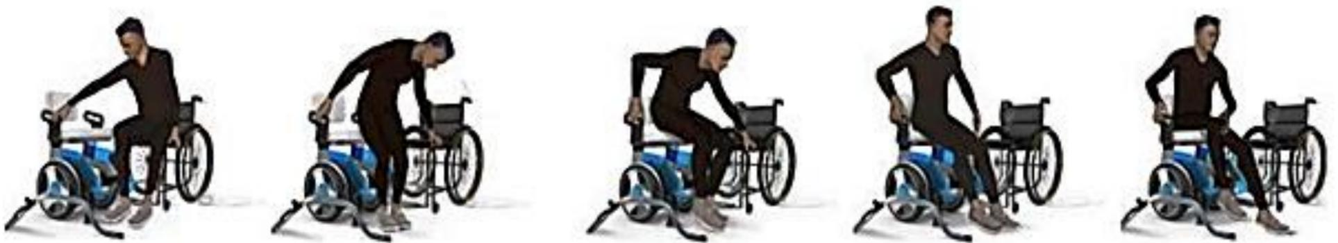
Pour réaliser cette manœuvre en toute sécurité, l'exigence Id.2.3 stipule que le transporteur ne doit pas se déplacer sur le sol pendant le transfert.
