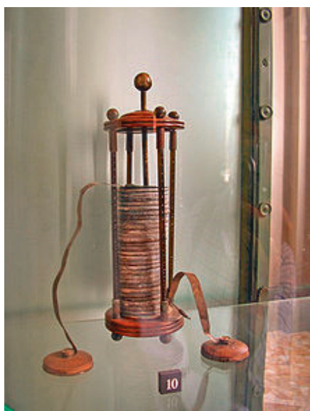
Figure 1. Photographie d'une pile Volta Source : Wikipédia
